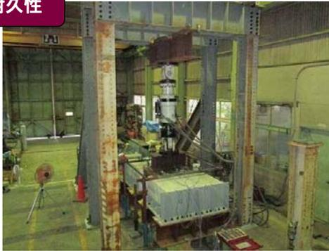
NEXCO 設計要領に記載の方法にて疲労耐久性試験を実施しています。(鋼部材には耐疲労鋼を採用)
